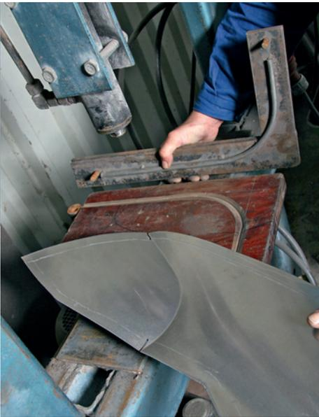
**12** Die Außenbleche bekommen den Knieschluss mit einem Rundstahlprofil eingepresst
