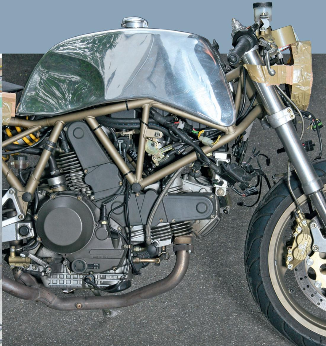
Der fertige Tank mit „Monza-Cap“ Tankstutzen. Die Linie folgt dem Gitterrohrrahmen und wird – ist der Tank ausgerichtet – sauber an ihm entlang gleiten. Ein Tank dieser Art kostet je nach Aufwand um die 1000 Euro
