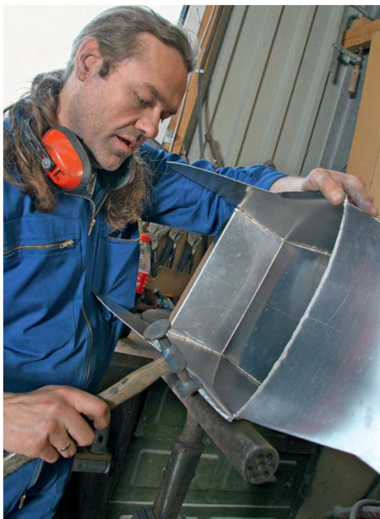
**10** Auf einem Rundstahl dengelt Lammers einen kleinen Radius an die Kanten, um sie sauber und rund verschweißen zu können
