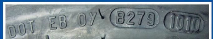
Der DOT Code findet sich an der Aussenseite des Reifens direkt über der Felgenkante. Vergewissern Sie sich erst, dass der Reifen das folgende Modell ist: METZELER 150/70 R17 M/C 69V TL Tourance. Dann sehen Sie auf der Seitenwand nach, ob es sich um den DOT Code **EB OY B279 0910** oder **EB OY B279 1010** handelt.
