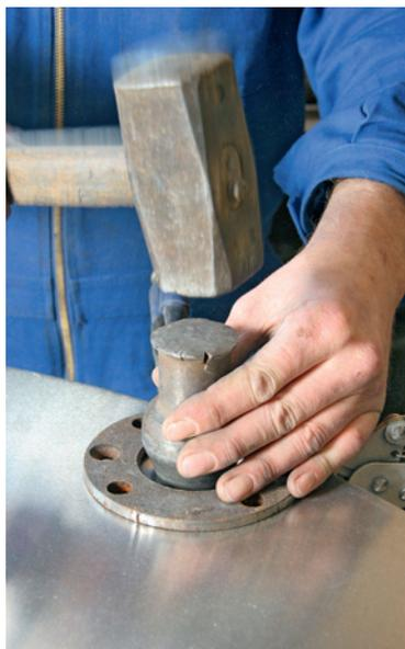
**17** Das Bördeleisen treibt die Lochkanten passgenau nach unten. Der Tankstutzen wird darin verschweißt
