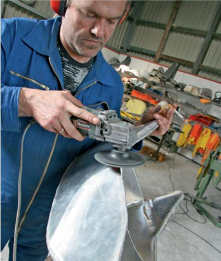
**20** Am Schluss werden die Schweißnähte komplett verschliffen und der Tank poliert
