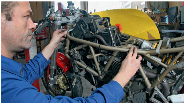
**6** Jetzt kommt der Tunnel. Die innere Form des Tanks. Er wird sehr groß, denn er muss später genug Platz haben, um die Elektrik des Motorrads unter zu bringen
