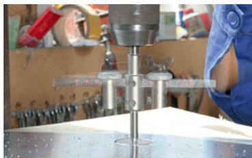
**16** Mit dem Kreisschneider auf der Ständerbohrmaschine wird das Loch für den Einfüllstutzen ins Blech gezaubert
