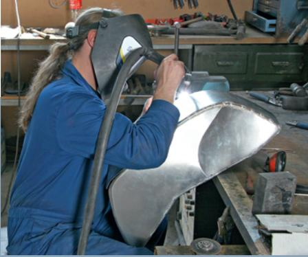
**19** Wenn alle Teile sitzen wird der Tank verschweißt und mit 0,3 bar auf Dichtheit geprüft
