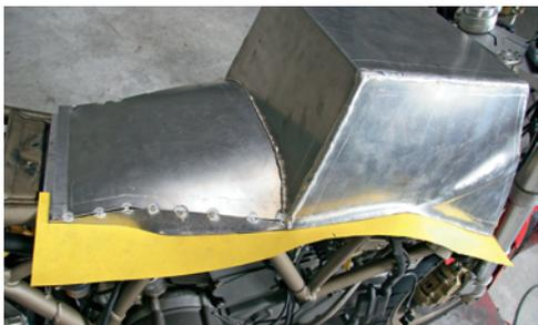
**11** 3D-Denken für den Knieschluss. Übergangsbleche verbinden später den Tunnel mit der Hülle
